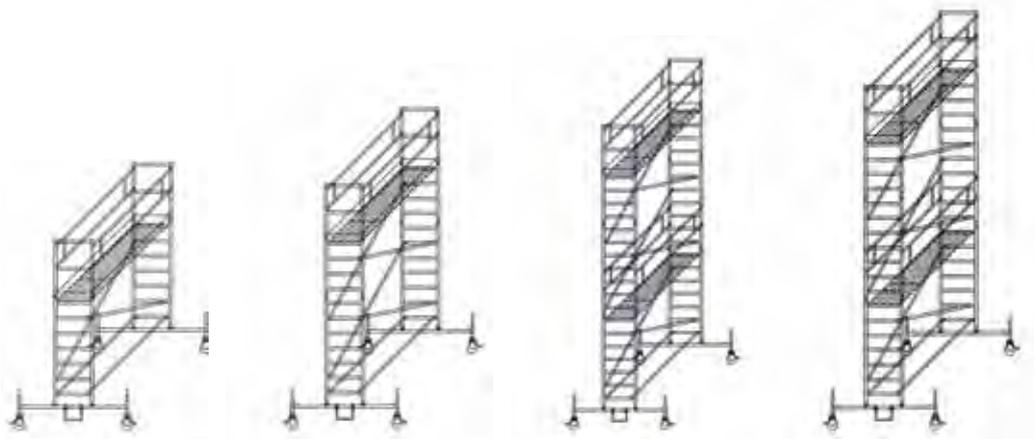
\* Traverses mobiles non contenues dans la livraison standard pour une hauteur de plate-forme de 2,45 m, car non nécessaires.
